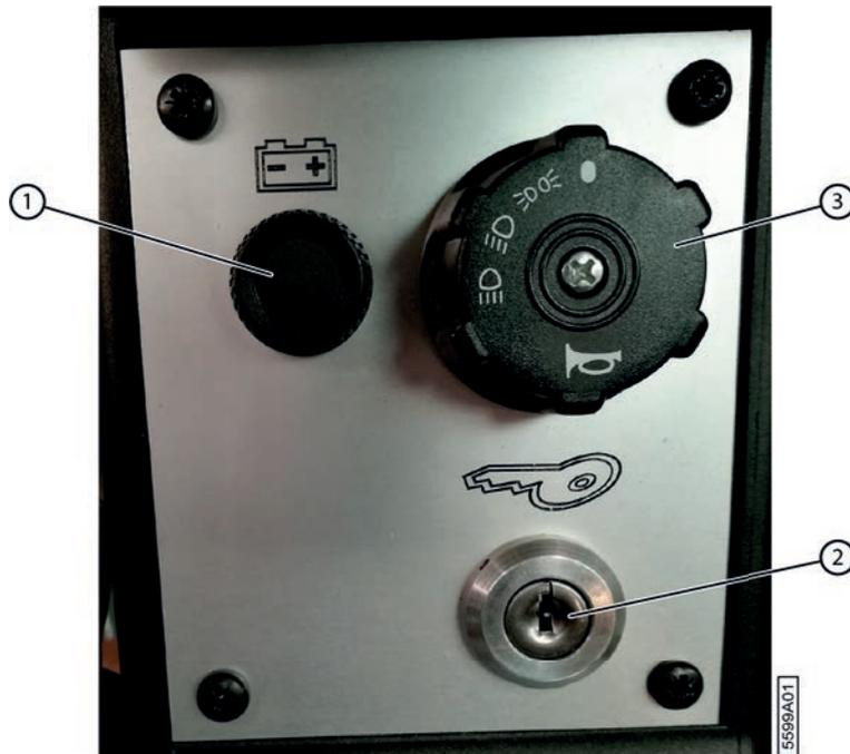
Fig. 66: Version 2 avec bouton rotatif
