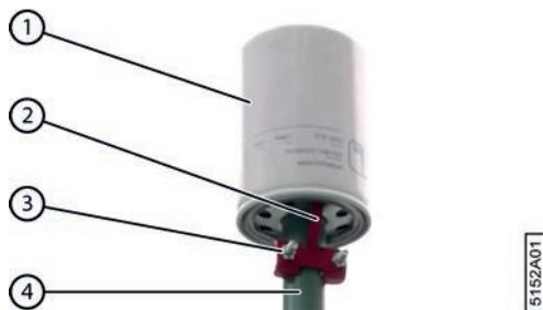
Fig. 113: Reniflard du réservoir hydraulique
