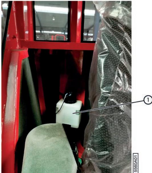
Fig. 14: Réservoir du liquide lave-glace
