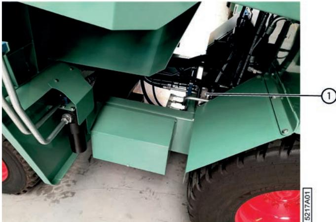
Fig. 187: Filtre du circuit de freinage
