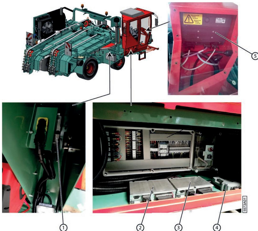
Fig. 168: Emplacement des contrôleurs
