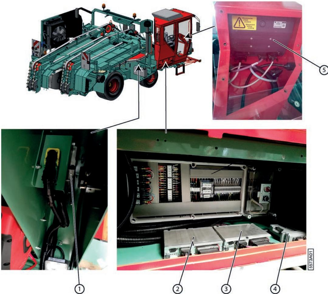
Fig. 28: Emplacement des contrôleurs
