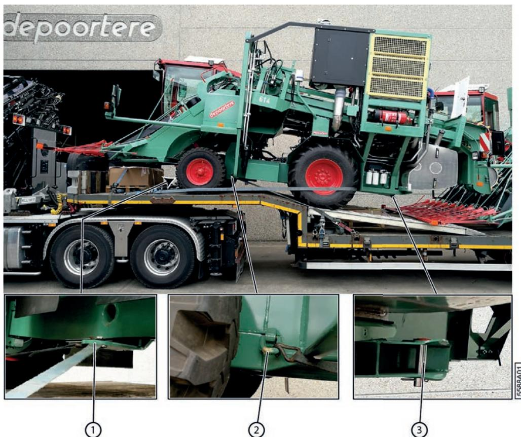
Fig. 47: Décharger la machine du camion
