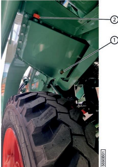
Fig. 107: Contrôle l'huile de l'engrenage de l'arracheur
