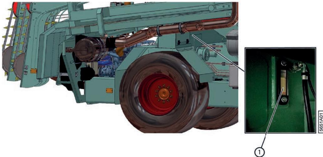
Fig. 132: Niveau huile hydraulique
