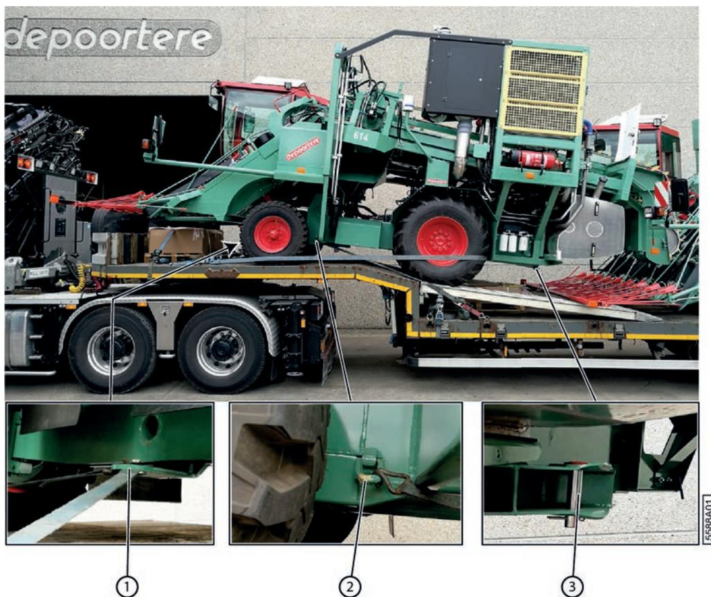
Fig. 46: Charger la machine sur le camion
