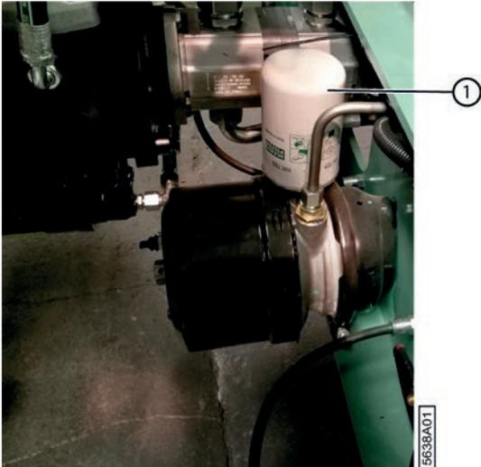
Fig. 114: Remplacer le filtre d'aération du frein de parking
