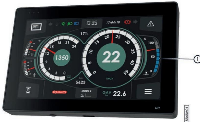
Fig. 127: Affichage du niveau d'AdBlue sur la fenêtre du mode Route
