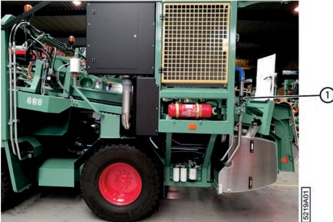
Fig. 185: Filtre d'aération du réservoir à carburant
