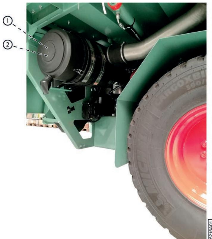
Fig. 183: Élément principal et élément de sécurité du filtre à air
