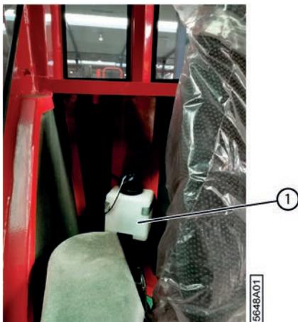
Fig. 129: Réservoir du liquide lave-glace
