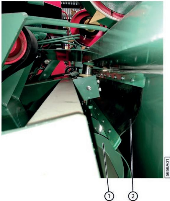
Fig. 138: Vérifier l'état du rabat en caoutchouc sur le vérin
